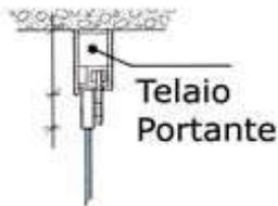
La struttura portante è in alluminio anodizzato (20 micron)\* o verniciato in polveri poliesteri. Le ante in cristallo temprato 10 mm. a filo lucido scorrono su binari con speciali cuscinetti in nylon. La viteria e i perni sono in acciaio INOX. Il tutto garantisce ottima qualità ed assenza di manutenzione.
