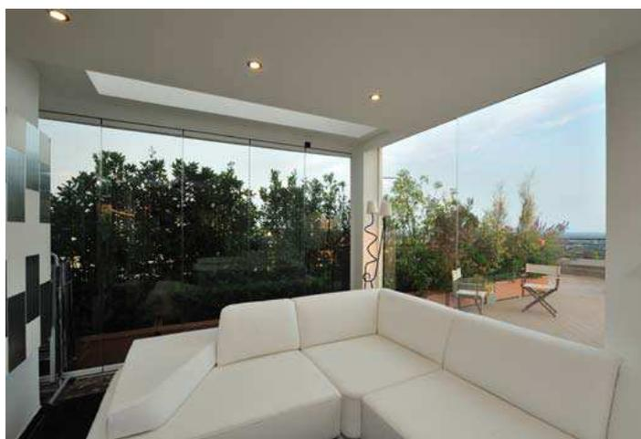
**Caratteristiche tecniche:** si tratta di ante che scorrono singolarmente su una guida superiore e una inferiore, senza telaio perimetrale, permettendo l'apertura parziale o totale della vetrata e garantendo un'ampia visuale panoramica. Le ante, ruotando fino a 90°, permettono un'agevole pulizia esterna dei vetri.
